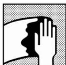
Очистка поверхности; удаление загрязнения поверхности перед шлифованием рекомендованным способом с использованием обезжиривателя M700.
