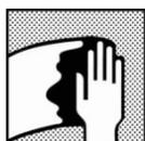
Очистка поверхности: удаление загрязнения поверхности перед нанесением 1K All Plastics Primer рекомендованным способом с использованием обезжиривателя M700.
