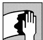
Очистка поверхности перед нанесением базового покрытия: удаление всех загрязнений, рекомендованным способом обезжиривания, используя рекомендованную последовательность применения обезжиривателей; сначала M600 или M700, затем M200.
