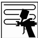
Нанесите первый полный слой на зону перехода, следующий слой нанесите с плавным выходом в сторону заполированной поверхности.
