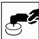
Полировку зоны перехода можно выполнить вручную или с использованием полировальной машинки с применением полировальных паст.
