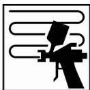
Нанесите 1-3 тонких слоя на зону перехода с плавным выходом в сторону заполированной поверхности.
