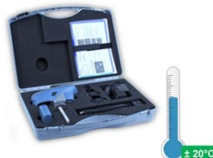
Хранение прибора и калибровочные пластины в чистоте и при комнатной температуре
