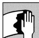
Очистите поверхность соответствующим обезжиривателем.
