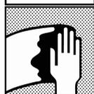
Обезжиривание подготовленной поверхности, используя обезжириватель на водной основе. Не допускайте контакта шпатлевки с водным обезжиривателем.
